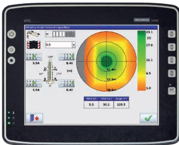
Моделирование подъема в кабине с помощью системы управления IC-1 Plus
